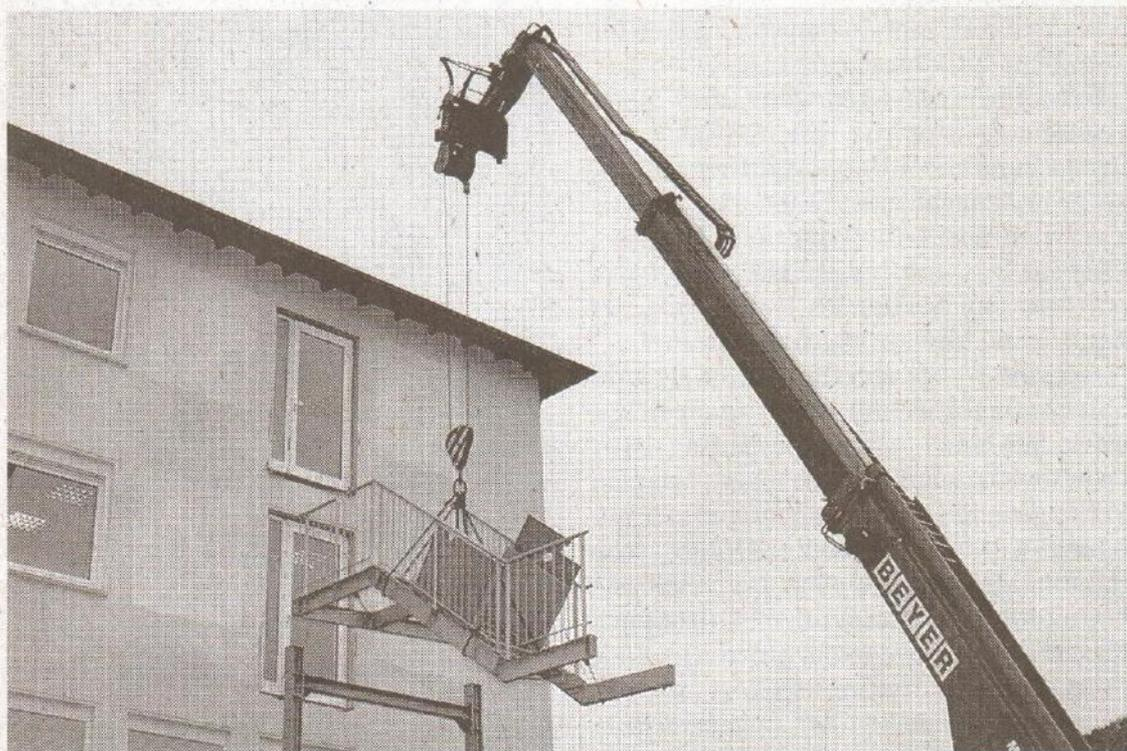
Mit den passenden Parametern und dem Anbaugerät hydraulische Seilwinde wird aus dem Allrounder ein flexibler Mobilkran mit überzeugenden vertikalen Werten. Foto: Beyer-Mietservice
