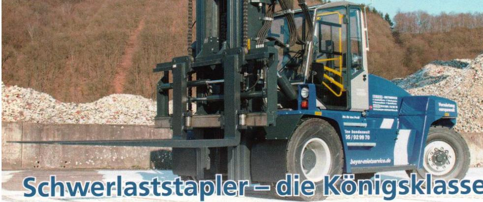
Kalmar-Großstapler: Überzeugen kann der Staplertyp mit einer max. Traglast von 16 t und einer maximalen Hubhöhe von 5.000 mm. Die Länge der Gabelzinken beträgt 2.400 mm.
