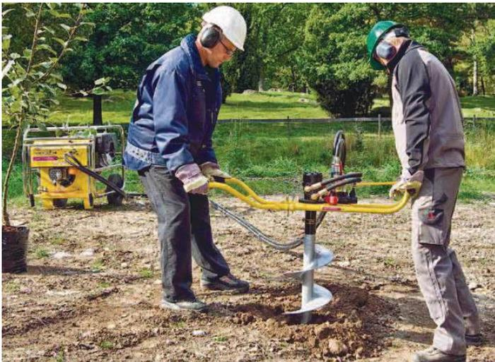
Pflanzlöcher leicht gemacht – selbst in festem Boden bohrt das kompakte und leistungsstarke Erdbohrgerät problemlos bis zu einer Tiefe von 1,3 Metern.
