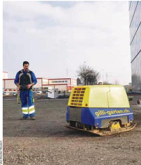
Ferngesteuerte Vibrationsplatte DPU 130 von Wacker Neuson.
