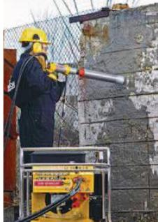
Ideal zur Freihandbohrung von Löchern selbst in härtestem Material ist das hydraulisch betriebene Kernbohrgerät LCD 5.
