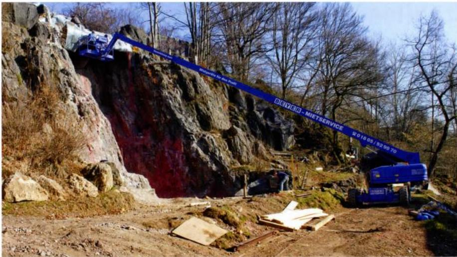
Dank der Hubhöhe und der seitlichen Reichweite der Teleskopbühne 279 KD wurden die Arbeiten an der Kulisse rechtzeitig abgeschlossen. | Foto: Beyer-Mietservice
