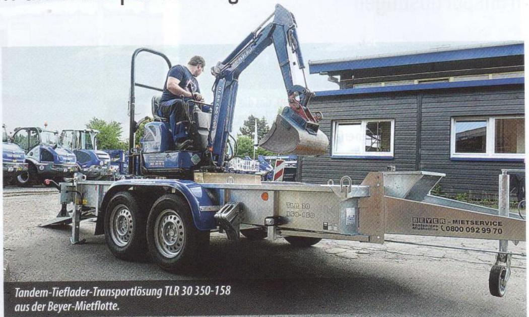
Tandem-Tieflader-Transportlösung TLR 30 350-158 aus der Beyer-Mietflotte.
