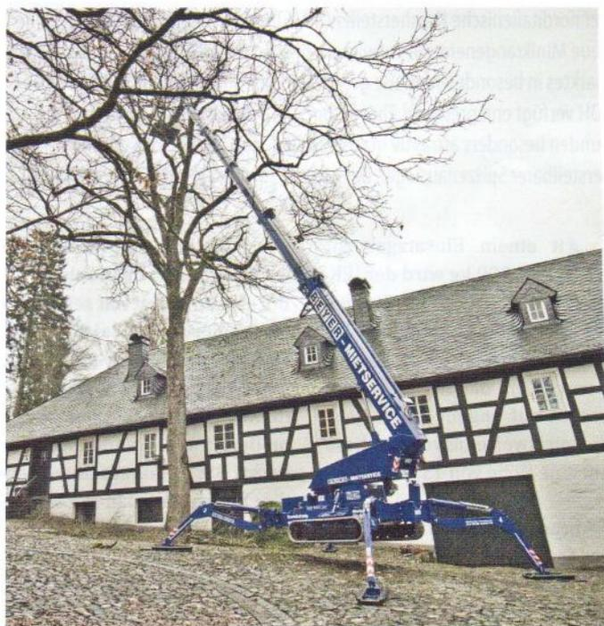
*Raupenarbeitsbühne im Einsatz für Baumpflegearbeiten: Mit einer Breite von 1,58 m und einer Höhe von 1,98 m gelangte die Arbeitsbühne auf Raupenfahrgestell (RAB 252 T D/E) problemlos durch einen engen Rundbogen in den Innenhof eines mittelalterlichen Schlosses.*
