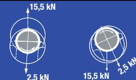
hydrostatisch verstellbare Umlaufgewichte ermöglichen den Einsatz sowohl auf Schwarzdecke (13 kN) als auch im Unterbau (18 kN). Erregerwelle doppelgelagert
