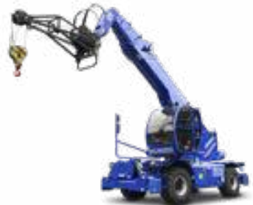
Gittermast mit Winde 2 t
