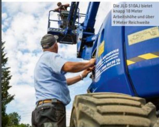
Die JLG 510AJ bietet knapp 18 Meter Arbeitshöhe und über 9 Meter Reichweite
