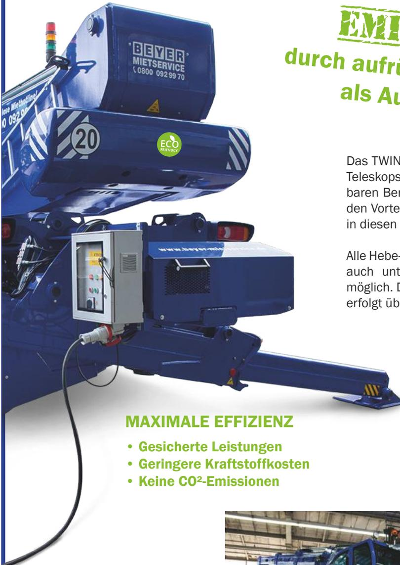
Das TWIN-ENERGY-System ist die optimale Lösung, um Teleskopstapler in geschlossenen oder nicht belüftbaren Bereichen emissionsfrei einzusetzen. Das bietet den Vorteil, die enorme Hebeleistung der Rotoren auch in diesen Bereichen zu nutzen.
