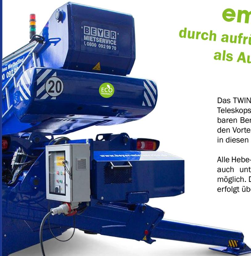
Das TWIN-ENERGY-System ist die optimale Lösung, um Teleskopstapler in geschlossenen oder nicht belüftbaren Bereichen emissionsfrei einzusetzen. Das bietet den Vorteil, die enorme Hebeleistung der Rotoren auch in diesen Bereichen zu nutzen.
