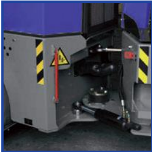
lebensdauer geschmiertes Teflon- Pendelgelenk
